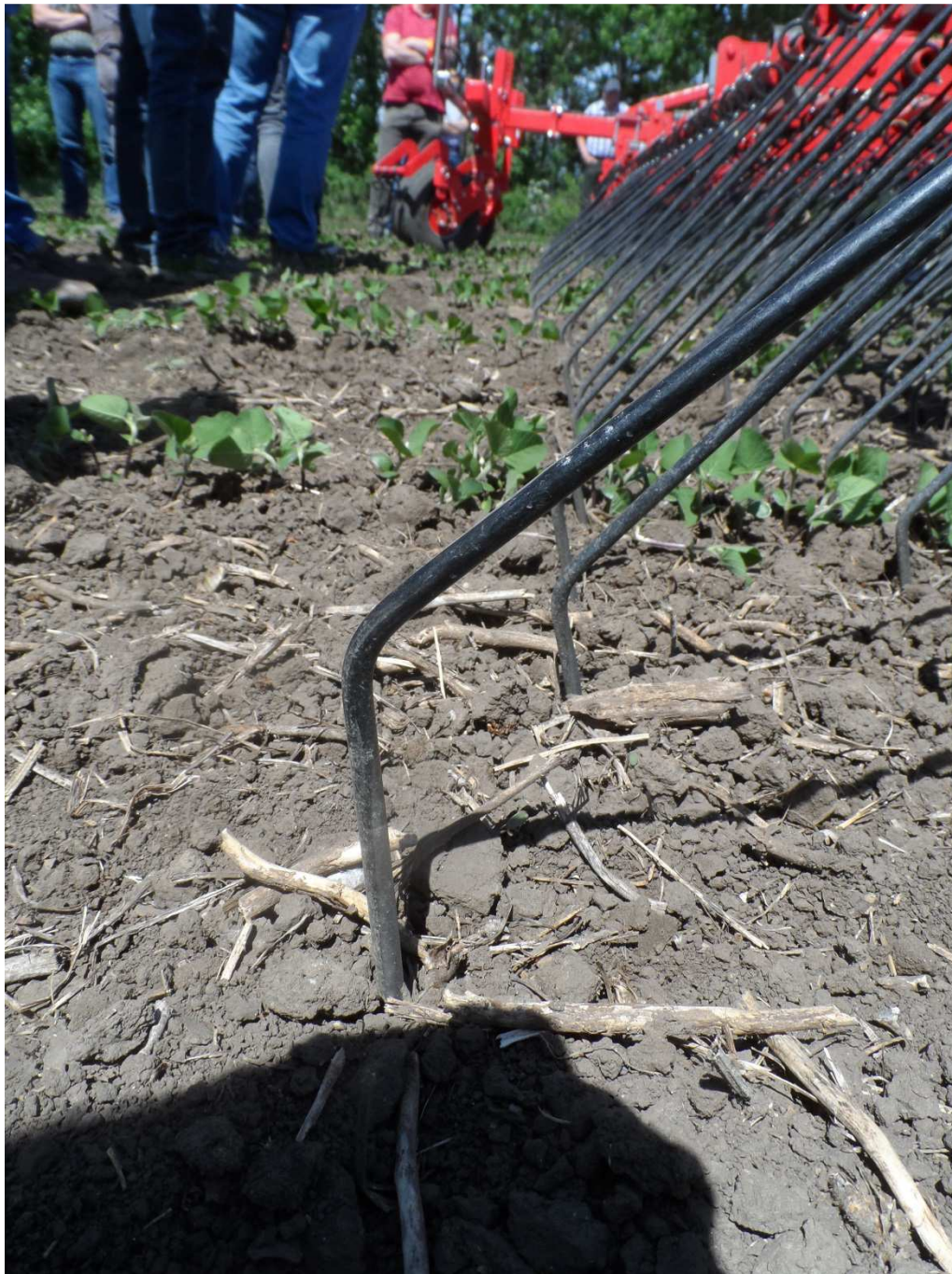
Abb.13: Einböck Aerostar-Exact mit 600mm Zinken (mit Spiralfeder), Verschleißstück im rechten Winkel zur Bodenoberfläche, gute Striegelwirkung
