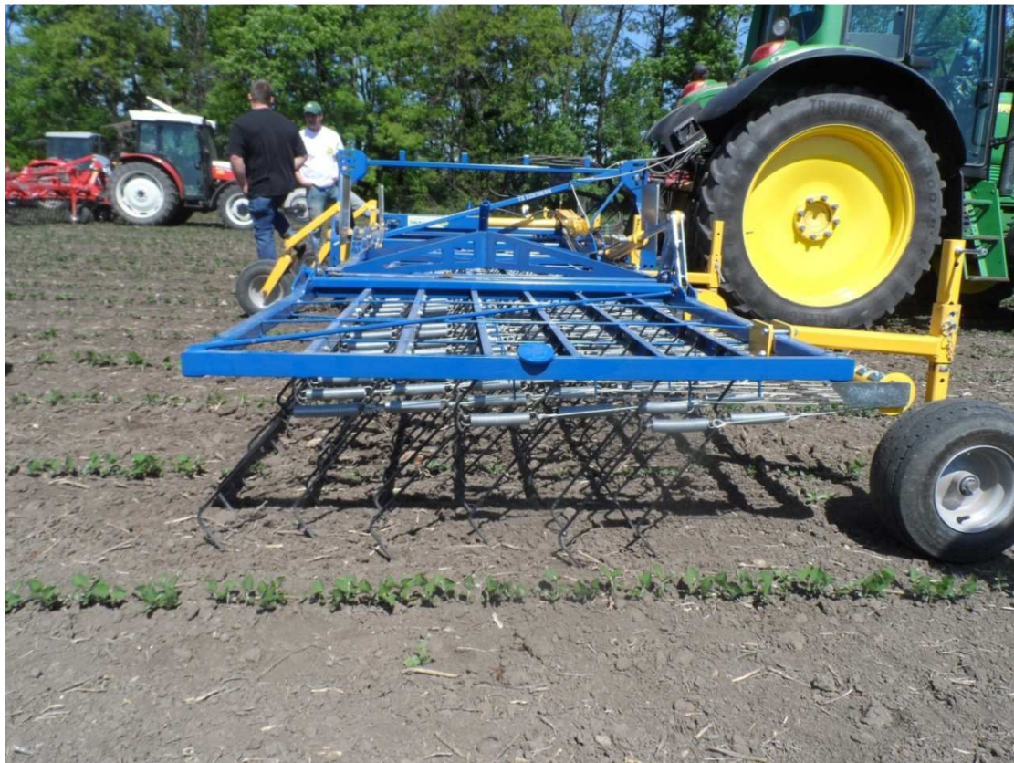
Abb.9: Treffler Präzisions-Zinkenstriegel mit einzeln aufgehängten Zinken und Stützrädern vorne und hinten.
